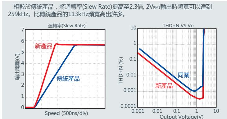
相較於傳統產品，將迴轉率(Slew Rate)提高至2.3倍，2V<sub>RMS</sub>輸出時頻寬可以達到259kHz。比傳統產品的113kHz頻寬高出許多。
